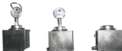
б. Два замка і один ключ: (2 вимикача оснащені двома однаковими замками і одним ключем дозволяється вмикати тільки один автоматичний вимикач)
