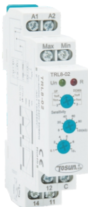
TRL8-02 реле контролю рівня рідини 10A, 12-240В (AC/DC) 1 або 2 рівня наповнення/осушення 1 SPDT 5-100 КОМ
